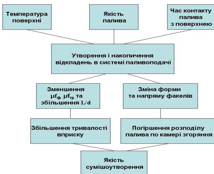
Рис. 4 – Фактори, що впливають на утворення вуглецевих відкладень на елементах системи паливподачі тепловозних дизелів та їх вплив на якість сумішоутворення у циліндрах двигуна
