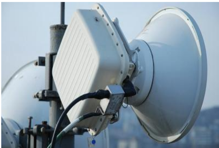
Рис.1 - Параболічна антена з блоком ODU для радіорелейного зв'язку
